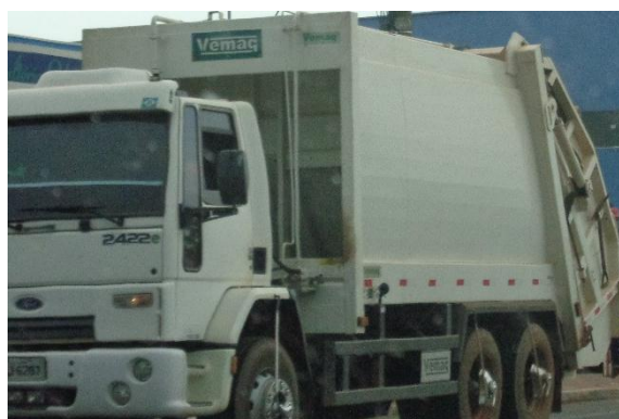
Figura 8 – Caminhão compactador utilizado para o serviço de coleta de RSDC no município de Itaquiraí/MS.
