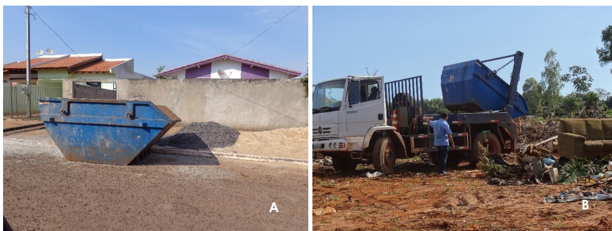
Figura 26 – Equipamentos utilizados na prestação do serviço de coleta dos RCC.
