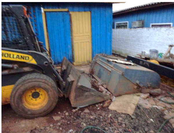
Figura 16 – Mini carregadeira mais varredora mecanizada utilizada pela empresa RPV no município de Itaquiraí/MS.
